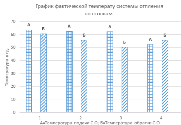
Рис. 4. Температура отопительных приборов стояка №1, 2, 3, 4, которая не соответствует температурному графику.
