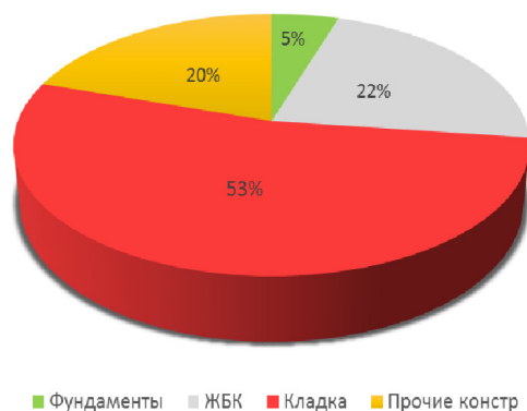
Рисунок 7. Распределение дефектов по конструкциям
