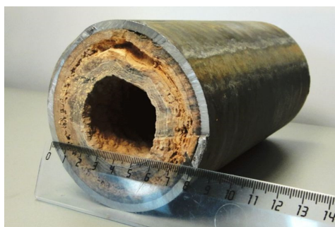
Рис. 2. Образец вырезки трубы на обратной разводящей магистрали Ду=89 мм
